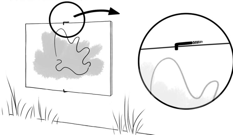
Rajouter 2 crochets (non fournis) en haut et en bas afin d'éviter que le produit ne se décroche avec le vent.
